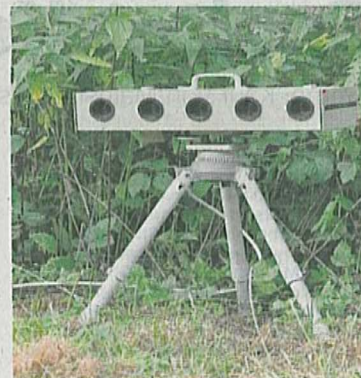
Fünf Sensoren erfassen die Geschwindigkeit von vorbeifahrenden Autos und Motorrädern.
