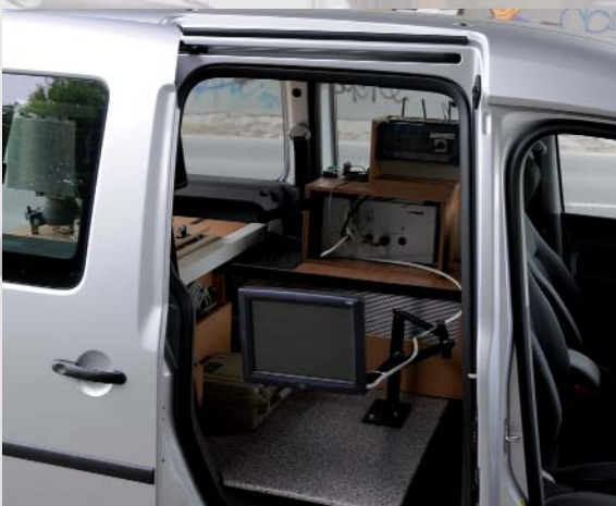
Monitorhalterung ist flexibel und kann in jede Stellung gebracht werden.
