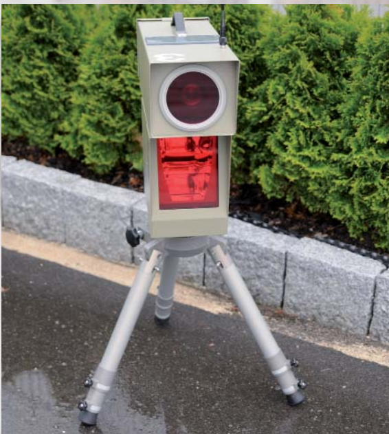
FE6.0 (WLAN) wird auf der anderen Straßenseite aufgestellt. Die Übertragung der Bilder erfolgt per WLAN und wird direkt im Einsatzfahrzeug angezeigt!
