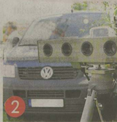
2 Dank des Fünffach-Sensors werden auch nebeneinander fahrende Autos erfasst
