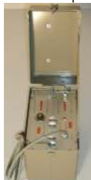
Energiekoffer mit Blitzwandler und Batterieeinschub (12 V Stromversorgung)
