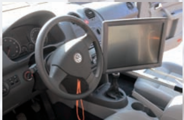
Monitor kann vom Fahrer oder Beifahrer bedient und nach dem Messen nach hinten geklappt werden
