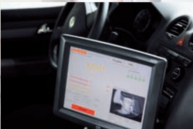
Monitor kann vom Fahrer oder Beifahrer bedient und nach dem Messen nach hinten geklappt werden
